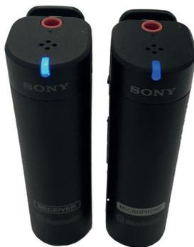
Brancher le micro sélectionné au transmetteur (port mini jack placé sur le dessus)
