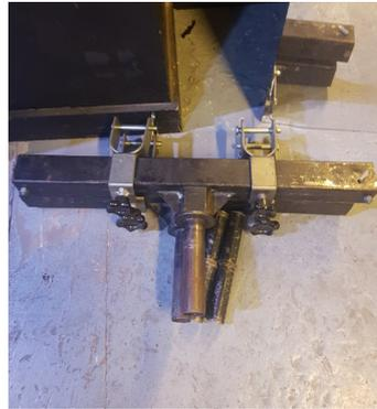
Référence pieds de levage charge min 75 kg - max 250 kg, hauteur 4 m, avec adaptateur de traverse 50mm.
